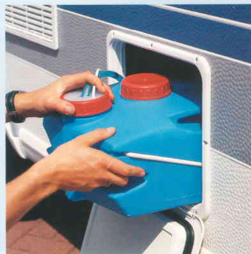
22 liter schoonwatertank makkelijk te bedienen (tot en met model 500 ).
