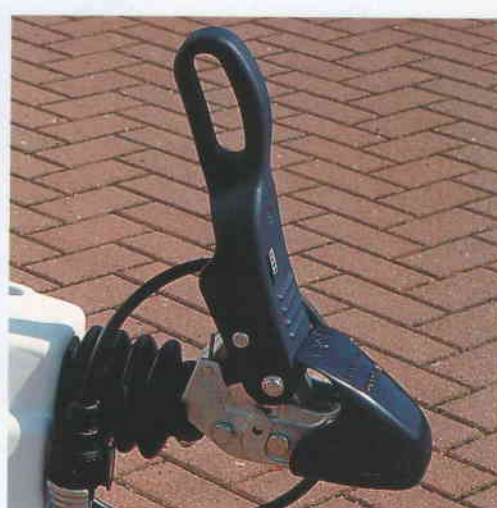
De stabilisatorkoppeling: veiligheid met één hendel.
