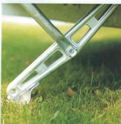
Stabiliteit garanderen de extreem belastbare verzwaarde uitdraaisteenen (vanaf model 540).
