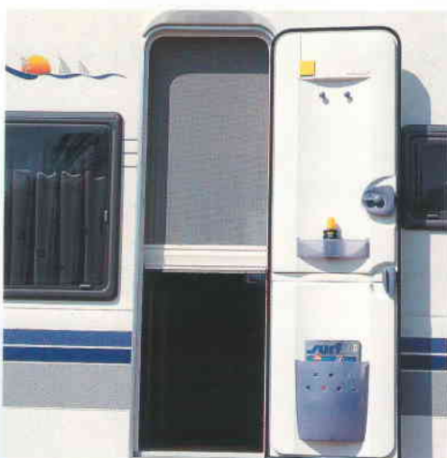
Heel vernuftig: muggenhor, voortentlamp en deelbare toegangsdeur met opbergvakken (de seriemodellen van De Luxe zijn niet voorzien van een muggenhor).
