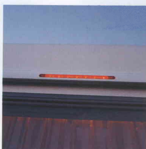
Een pluspunt voor uw veiligheid: merkieslijst met geïntegreerd derde remlicht en breedte lichten.
