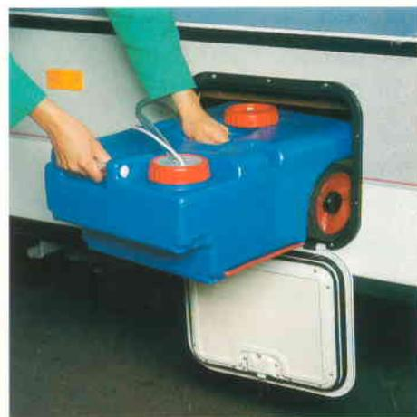
*Kinderleicht ist das Einsetzen des 28 l-Frischwassertanks. Zum bequemen Transportieren ist er zusätzlich mit Rollen ausgestattet.*
