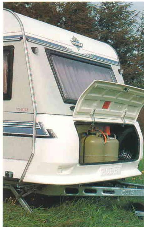
Draglåsen gjør det umulig å koble av, eller endog stjele hele koblingen. Vognen er samtidig sikret mot å løsne under fart. ● Åpningsbare vinduer med myggenetting og rullegardin finnes i alle modeller. De doble temovinduene sørger for god isolering. ● Baklyktkonsollen har innbygde lykter og nummerskiltbelysning.
