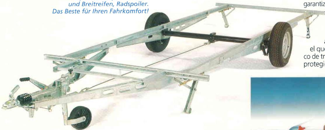
*Die verbesserte Drehstabfederachse (System Porsche) mit BPW®-ECO Kompaktlagerung. (Patent angemeldet) Trommelnabe, Kompaktlager und Achsenmutter bilden eine geschlossene Einheit. Kompaktlager durch Spezialfett wartungsfrei! Extrem servicefreundlich mit garantiert hoher Lebensdauer. Innovative Technik im Detail!*
