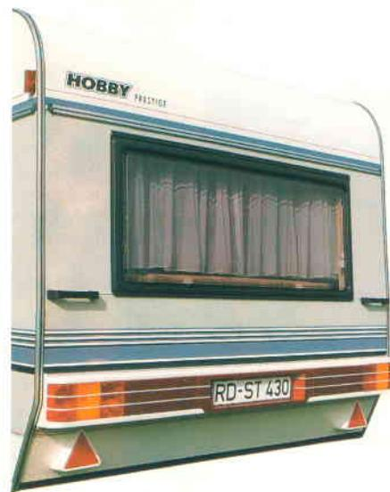
*Heckstoßstange mit durchgehend integrierten Schlußleuchten und Nummernschildbeleuchtung.*
