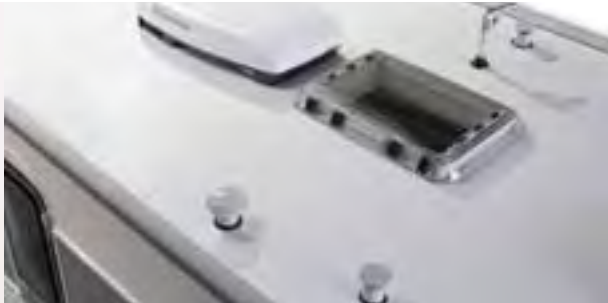
Polyester dak beschermt tegen hagel en steenslag
