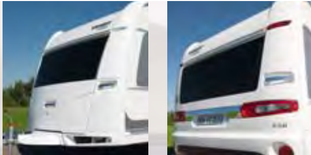
Voor- en achterzijde vervaardigd uit LFI (vezelversterkt polyurethaan), bijzonder sterk en vormvast
