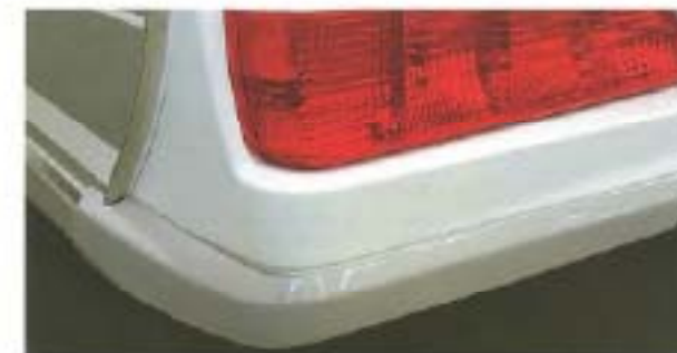
Hoekelamenten rechts- en links achter zijn als losse componenten gemonteerd.
