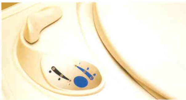
Toilet met LED aanduiding om in één oogopslag de hoeveelheid spoelwater en de inhoud van de afvaltank af te kunnen lezen.
