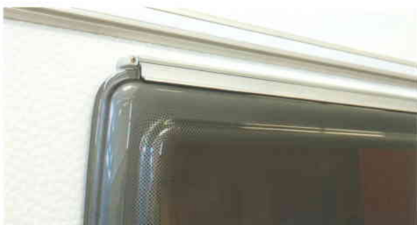
Ramen met aparte markiezenrails boven het raam, waardoor markiezen eenvoudiger kunnen worden bevestigd.
