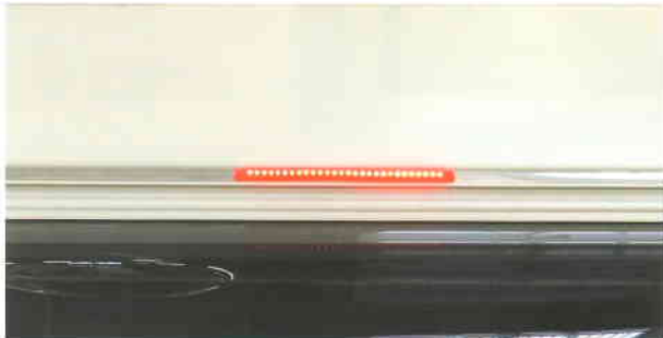
In sierlijst geïntegreerde LED breedte- en remlichten.
