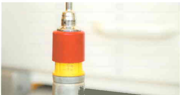
Neuswiel met gewichtsaanduiding voor het eenvoudig controleren van de kogeldruk.
