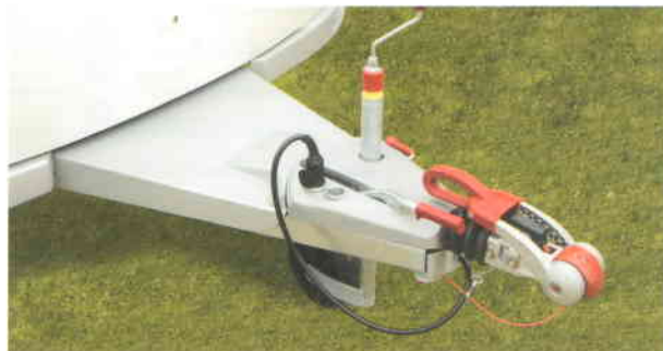
Innovatieve dissel met een compleet zelfdragende bodem voor de disselkast. Daardoor ontstaat een langere vrije dissellengte. De Dynamische torsiebelasting van de dissel wordt niet meer door de disselkast aan de opbouw doorgegeven.
