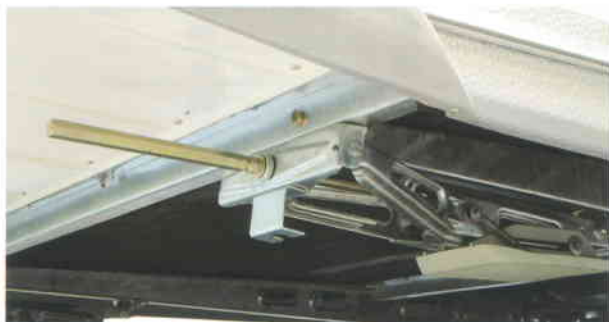
Uitdraaisteunen voor en achter met verlengde spindel voor comfortabeler gebruik.
