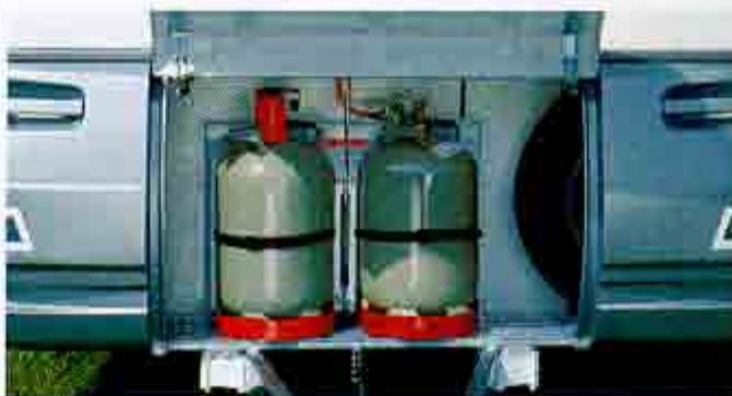
Zusätzlichen Stauraum bietet der Flaschenkasten (für 2 x 11 kg Gasflaschen und mit Reserverad- halterung). Der Deckel läßt sich durch Teleskoparme bequem nach oben klappen.
